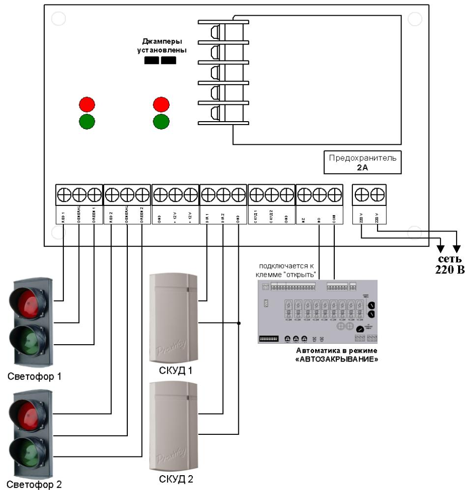
Установите Блок светофорного регулирования в любом доступном для вас месте, по-возможности в минимальной удалённости от датчиков безопасности и системы контроля доступа (при её использовании). Монтаж производите соответствующим инструментом. Подсоедините монтажные провода к клеммам, согласно выбранной схеме, после чего установите их в колодки на плате Блока.
