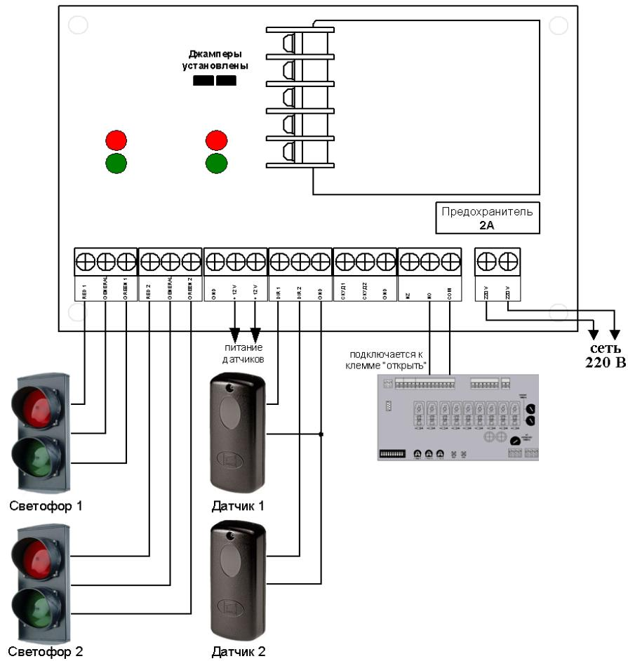
**Схема № 3 подключения без фотоэлементов с системой управления контроля доступа с малой интенсивностью движения (не более 1 машины в минуту).**
