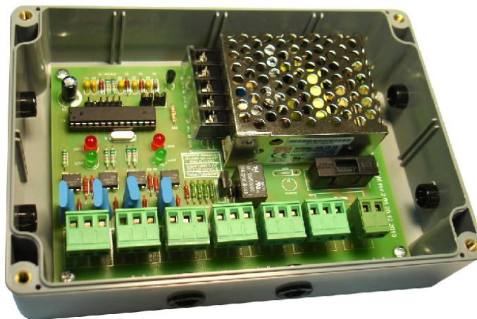
Корпус устройства выполнен из ABS пластика с соответствующими отверстиями для соединения блока управления с дополнительными устройствами.
